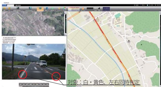
AI(人工知能)自動診断で剥離率を算出
